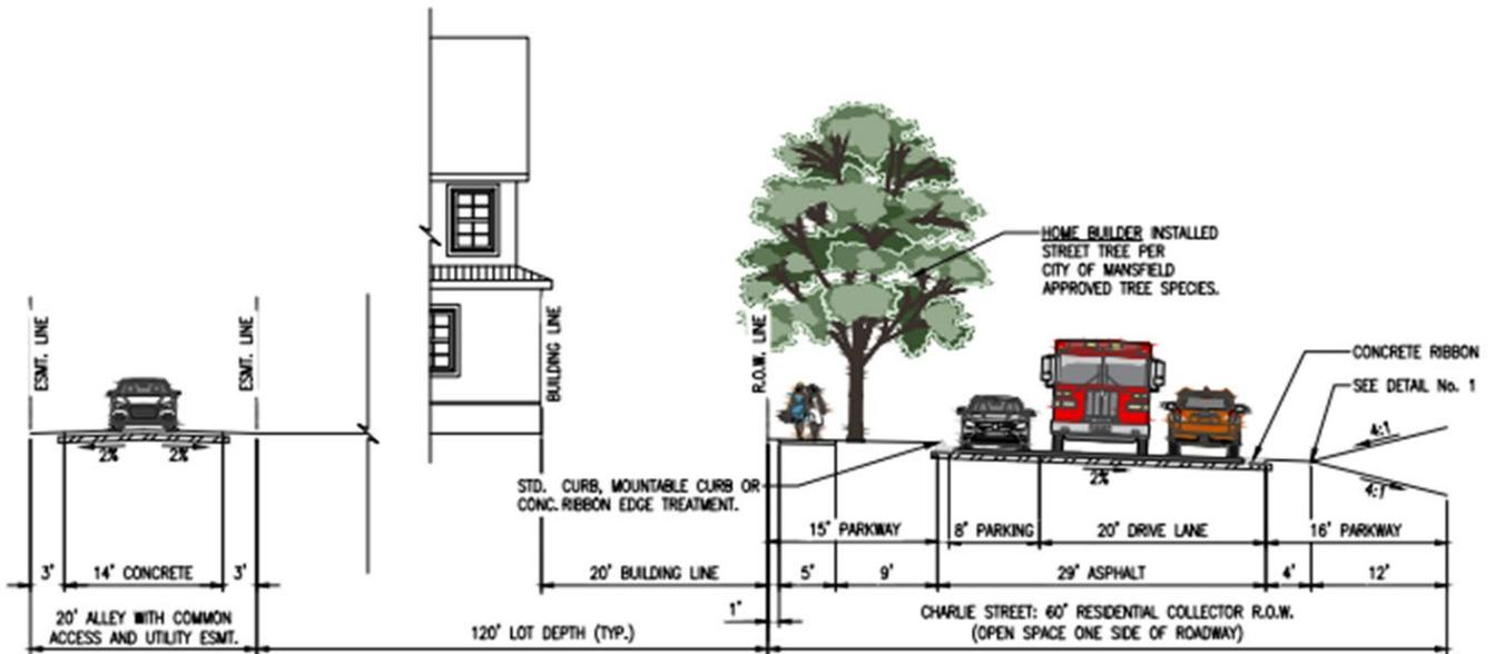
**SECTION G-G – ASPHALT COLLECTOR
