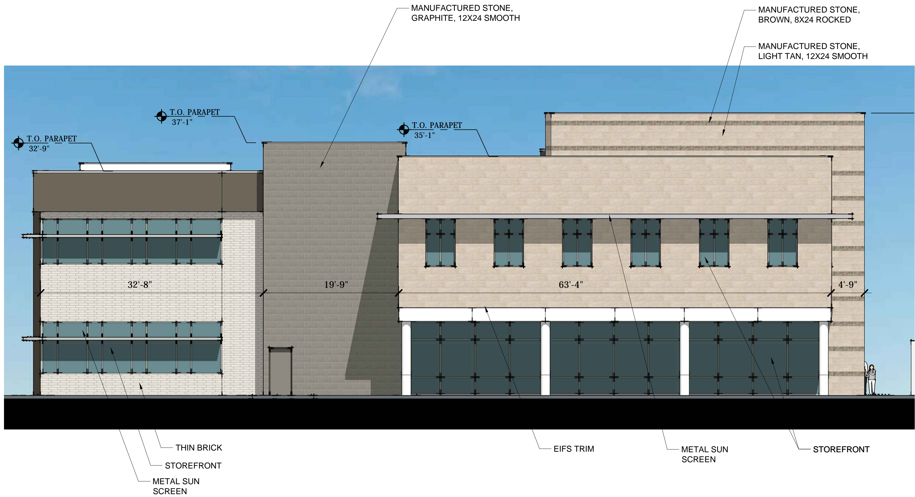
04 NORTH ELEVATION SCALE: 1/8" = 1'-0"
