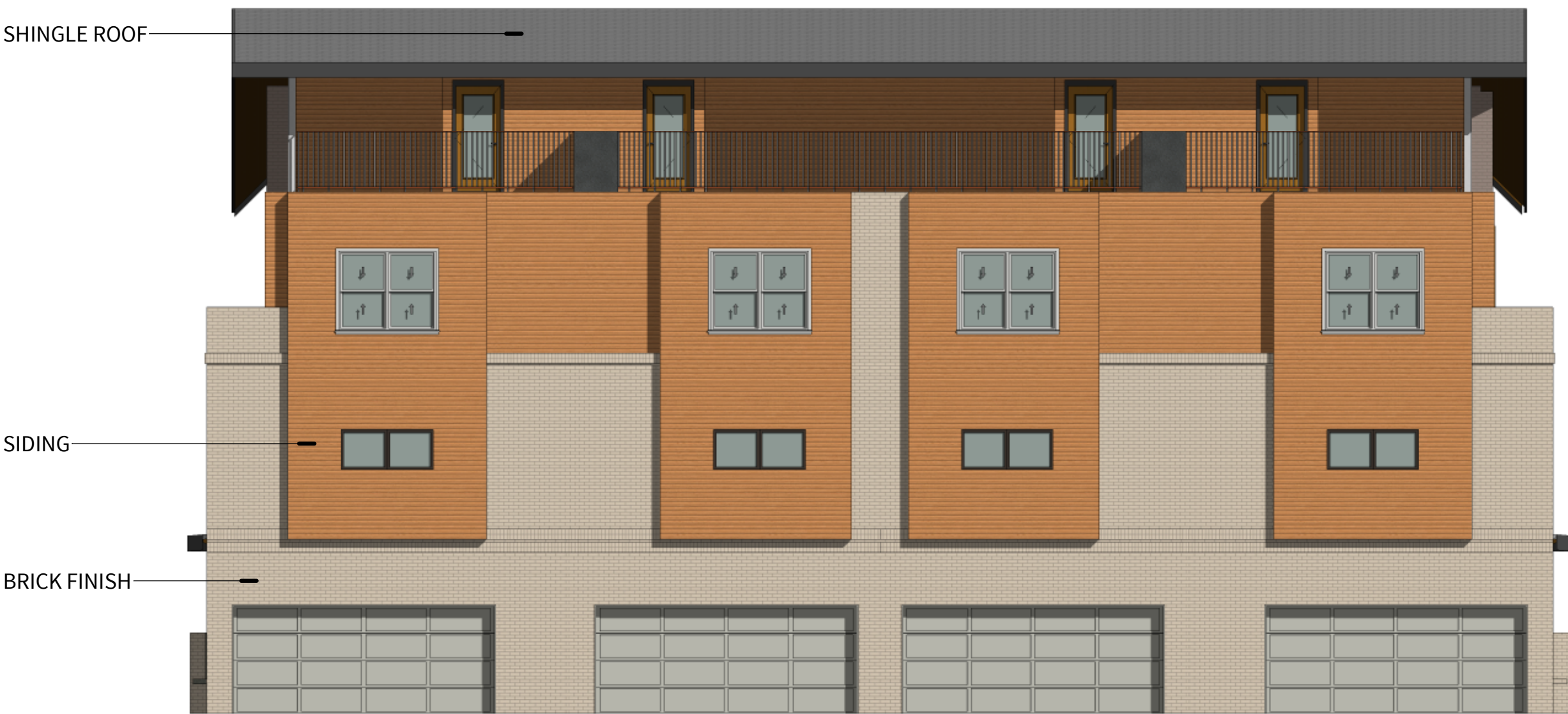
② SOUTH ELEVATION SCALE: 1/8" = 1'-0"
