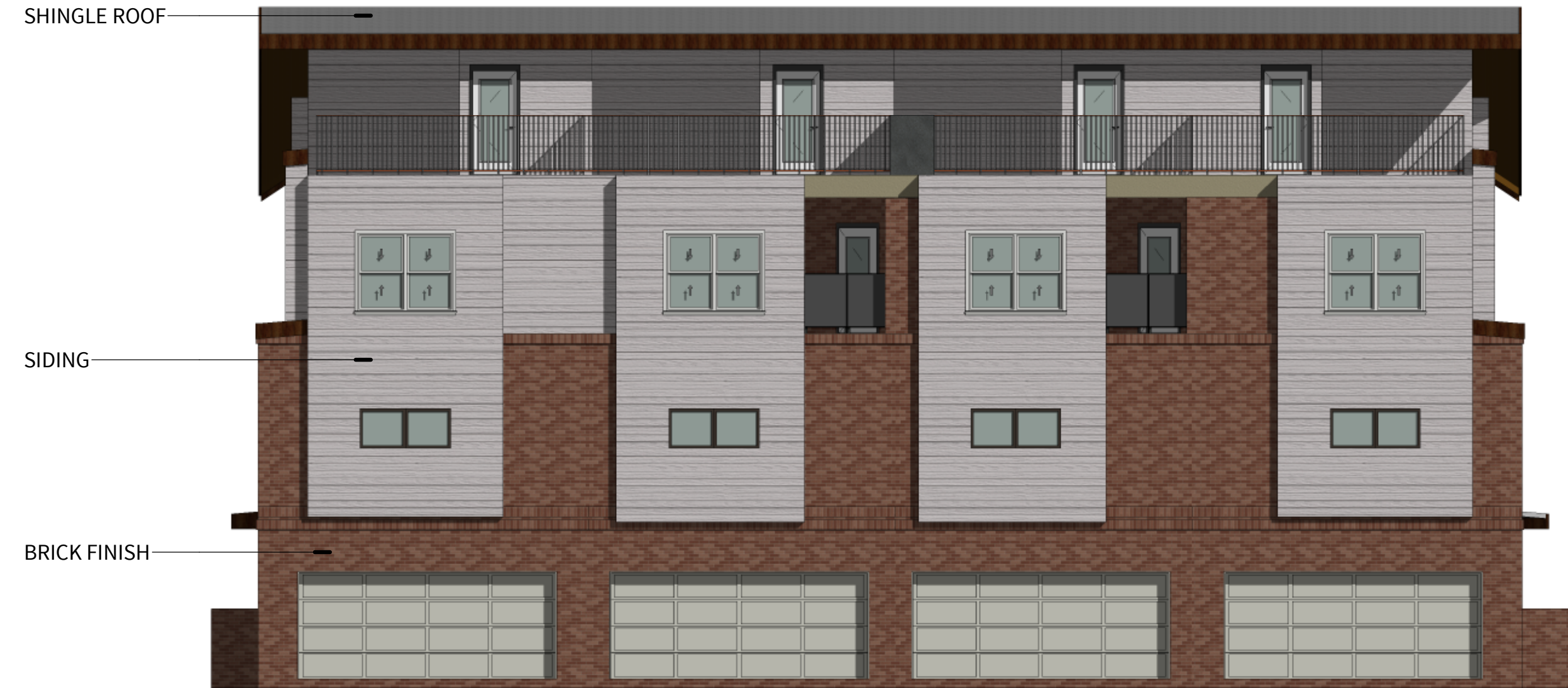
② SOUTH ELEVATION SCALE: 1/8" = 1'-0"
