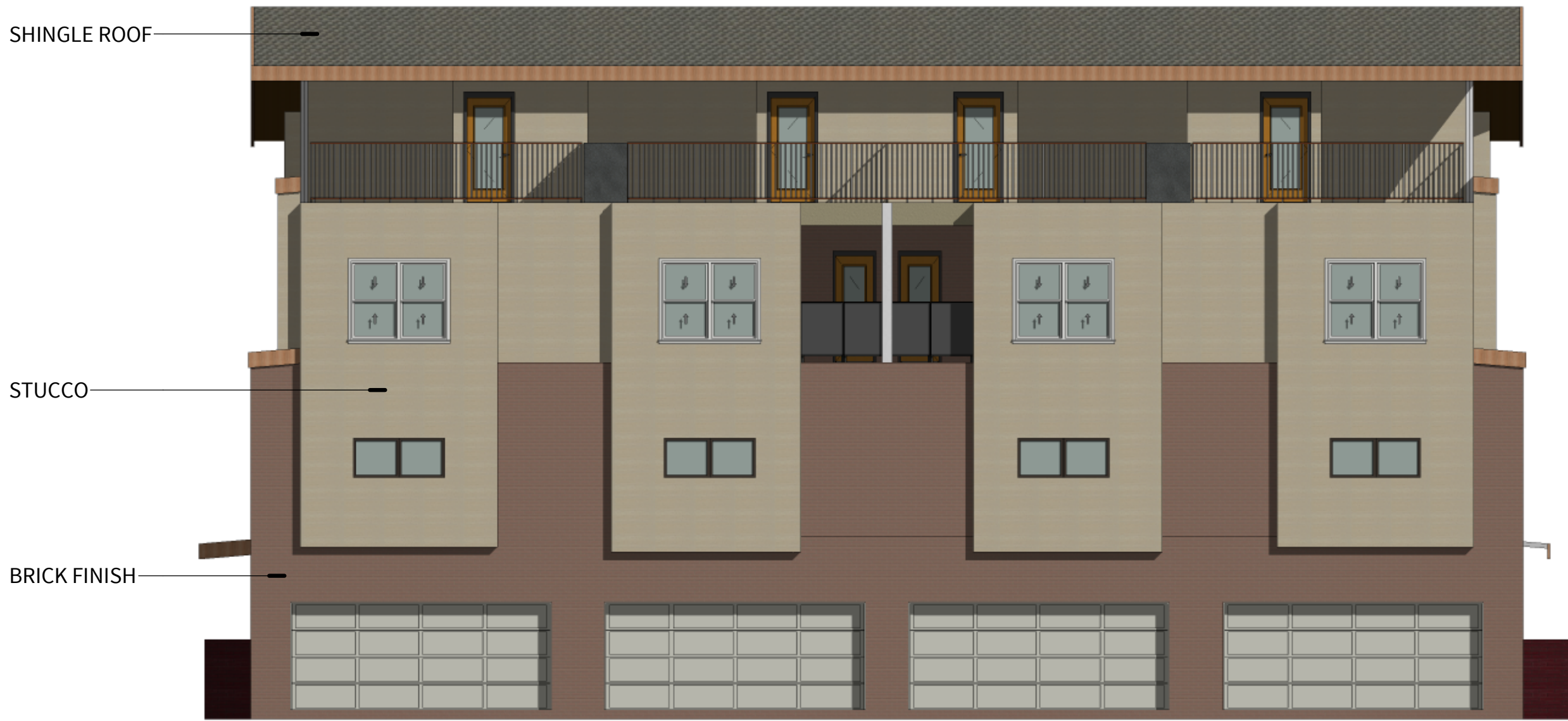
② SOUTH ELEVATION SCALE: 1/8" = 1'-0"
