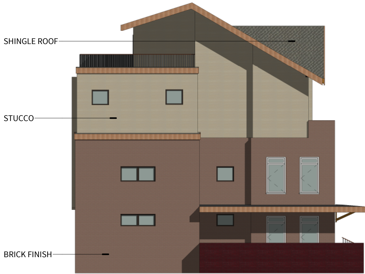
③ EAST ELEVATION SCALE: 1/8" = 1'-0"
